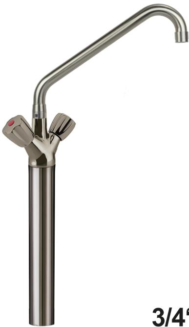
**Artikel-Nr.:** 1S.3055.21E6.0**Zolltarifnummer:** 84818019**Shop-URL:** <https://armag.de/1S.3055.21E6.0>**Material der Armatur:** Edelstahl**Steuerelement:** 1/2" Fettkammer Oberteil**Submarke:** classic**Armaturenart:** Zweigriffmischer**Ausladung:** 300 mm**Höhe bis Auslauf:** 470 mm**Gesamthöhe:** 520 mm**Montageart:** 1-Loch-Montage**Montagebohrung:** Ø 35 mm**Wasseranschluss:** 3/4" ÜM**Anschlussart:** druckfest**Besonderheit:** Schwenkbarer Auslauf**Höhe der Säule/Füße:** 300 mm
