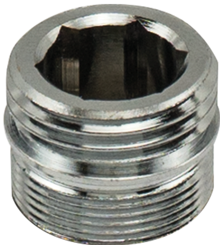
Gewindenippel M20x1 x 1/2" - SW 14 mm innen (AG x AG) MC
