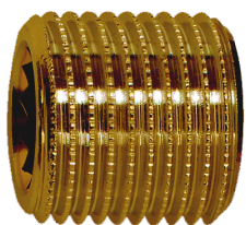
Gewindenippel 1/2" x Ø 13 L 20 mm (AG x IG) MS roh
