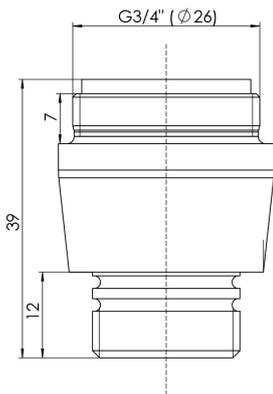
**[Adapternippel zu Körper A1-1250\\_2 mit 3/4" AG - IGØ 18,3 mm - iSW 15 mm](#)**
