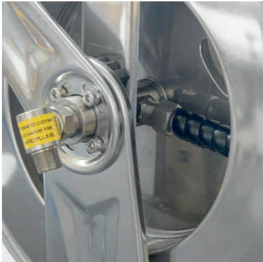
**6.** Ziehen Sie die 3/4" Überwurfmutter an (Gabelschlüssel 30) und überprüfen Sie ob sich der Schlauch hinter der Überwurfmutter nicht mehr drehen läßt. Sollte sich der Schlauch von Hand noch drehen lassen ist er nicht fest genug angezogen.
