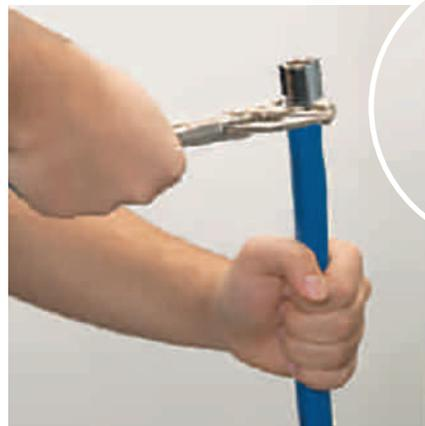
**4.** Die konisch verlaufende Innenschraube wird mit einem Inbusschlüssel in den Innenschlauch eingedreht. Gleichzeitig sollte die Aussenhülse mit einem Gabelschlüssel festgehalten werden.
