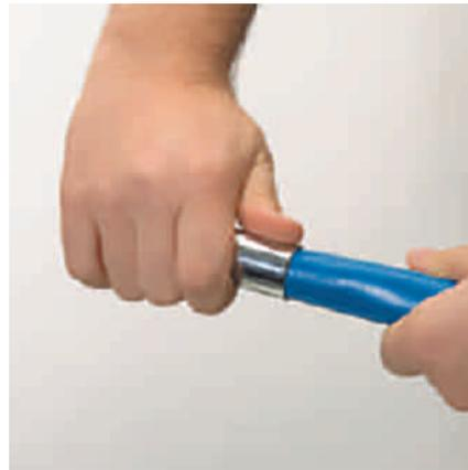
**3.** Die Hülse soll bis ca. 3/4 ihrer Länge im Uhrzeigersinn auf den Schlauch aufgedreht werden (In der Hülse ca. 10 mm Gewinde bis zum Schlauch frei lassen für das Gegenstück/Innenschraube). Bei Schwergängigkeit kann ein Gabelschlüssel hilfreich sein.
