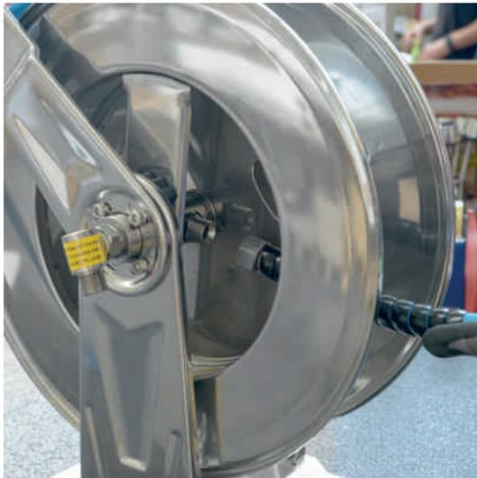
**5.** Setzen Sie die 3/4" Überwurfmutter von Hand an den Wasseranschluß. Dichtungen sind keine notwendig da dieses System konisch dichtet.
