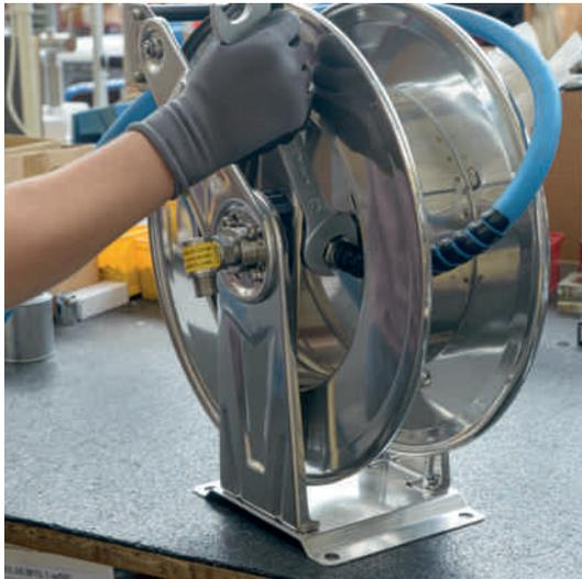
3. Führen Sie nun den Ersatzschlauch durch die Schlauchführung. Achten Sie beim Original-Ersatzschlauch mit der verpressten Verschraubung darauf das Sie die Seite mit dem schwarzen Schlauchschutz an der Trommel anschliessen.
