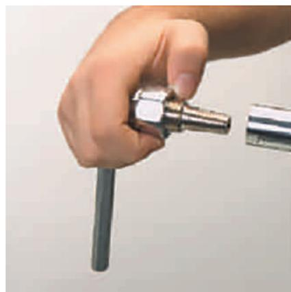
**5.** Der Schlauch wird durch Aussenhülse und Innenschraube wasserdicht verquetscht. Deshalb ist es wichtig das die Schlauchverschraubung komplett eingeschraubt wird und danach 1/4-umdrehung wieder geöffnet wird damit sich die Überwurfmutter frei drehen lässt.
